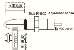
包括温度、电压影响在内，没有误动作从能用的检测面到检测面到检测物体通过位置的距离。
