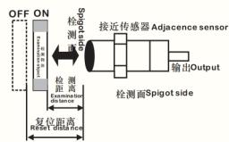
按指定方法移动检测物体，从基准位置（基准面到测定动作（复位）的距离）
