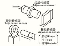
为测定基本性能作为标准的检测物体，形状、尺寸、材料已决定的。
