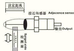
包括温度、电压影响在内，没有误动作从能用的检测面到检测面到检测物体通过位置的距离。
