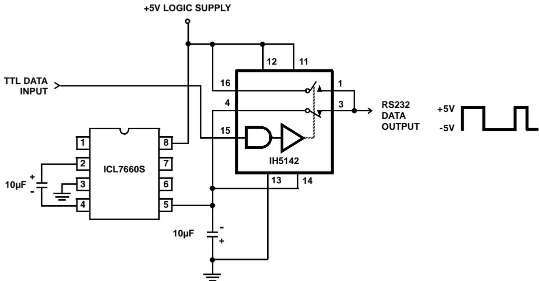
FIGURE 21. RS232 LEVELS FROM A SINGLE 5V SUPPLY
