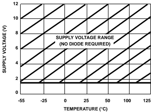
FIGURE 1. OPERATING VOLTAGE AS A FUNCTION OF TEMPERATURE
