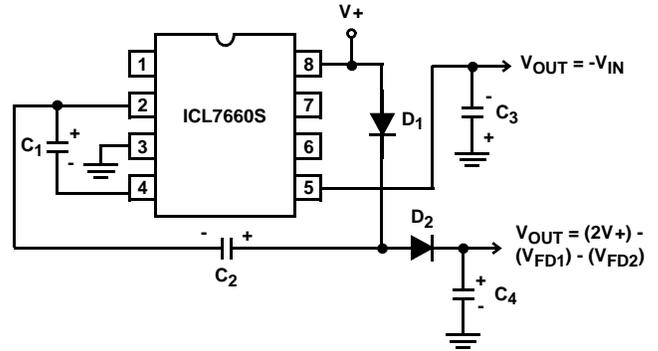
FIGURE 18. COMBINED NEGATIVE VOLTAGE CONVERTER AND POSITIVE DOUBLER
