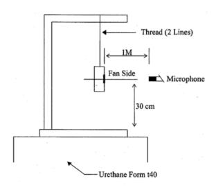
1 METER FROM MICROPHONE TO FAN INTAKE
