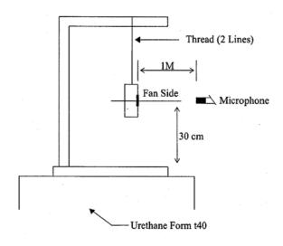
1 METER FROM MICROPHONE TO FAN INTAKE
