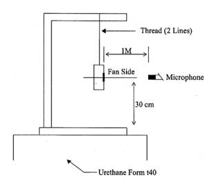
1 METER FROM MICROPHONE TO FAN INTAKE
