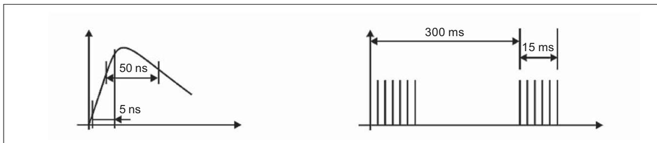
Drugim typem zakłóceń, często występujących w instalacjach niskiego napięcia, są udary zwane **SURGE**, występujące w liniach zasilających na skutek wyładowań atmosferycznych. Podobne zakłócenia mogą wywoływać również procesy łączeniowe dużych mocy, np. przełączanie obciążeń pojemnościowych, itp.
