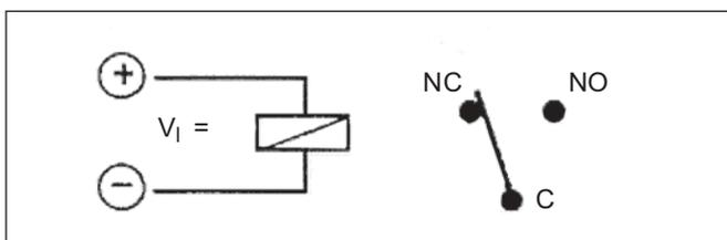
Dlatego też posiada on polaryzację magnetyczną zależną od biegunowości napięcia zasilania. Teraz, aby przełączyć przełącznik do stanu OFF, musi on być zasilony napięciem o przeciwnej biegunowości w celu zmiany polaryzacji magnetycznej rdzenia. Zmiana jedynie biegunowości zasilania nie spowoduje zwolnienia przełącznika. W celu zwolnienia przełącznika musi być zmieniona biegunowość, a wartość zasilania energią musi znajdować się wewnątrz zakresu wartości aktywacji (pobudzenia).
