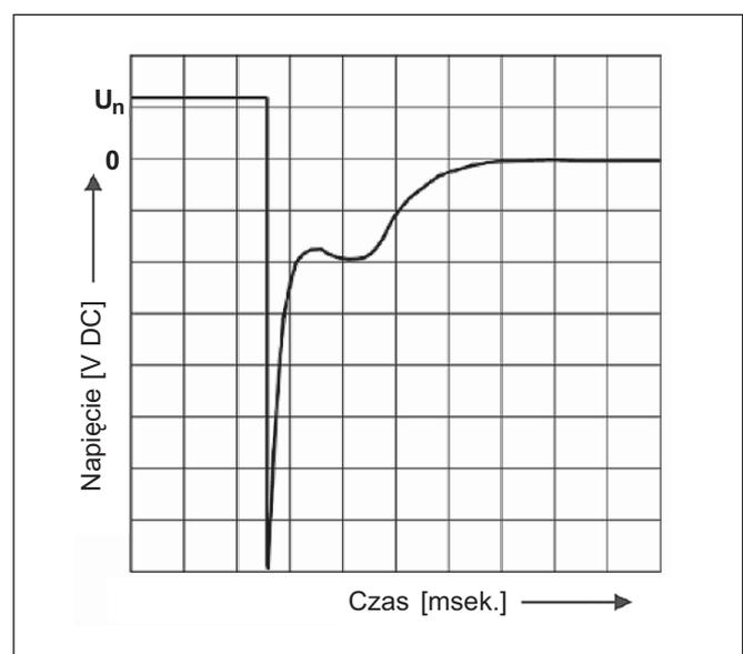
Rys. 10. Napięcie na cewce AC podczas wyłączenia
