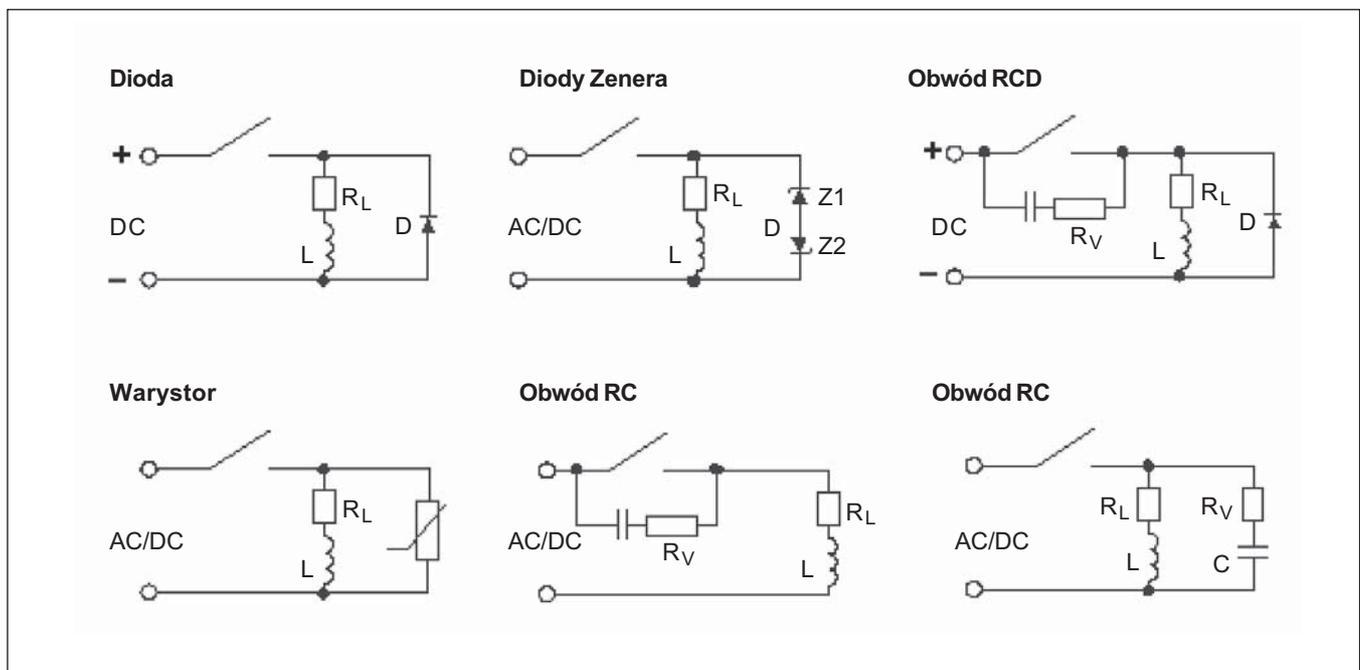
Innym elementem zabezpieczającym o charakterystyce prądowo-napięciowej podobnej do diody Zenera jest **warystor**. Dla małych napięć wykazuje on dużą rezystancję i wtedy jest praktycznie wyłączony z obwodu, natomiast gdy przekroczy on pewną wartość, charakterystyczną dla danego typu warystora, jego rezystancja szybko maleje i bocznikuje on wtedy swoją rezystancją wewnętrzną obciążenie indukcyjne.
