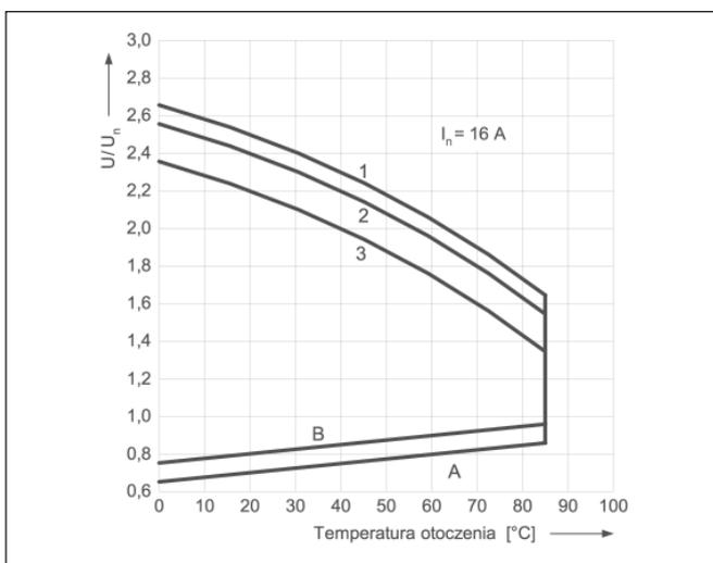
**A** - zależność napięcia zadziałania od temperatury otoczenia przy braku obciążenia na stykach. Temperatura cewki i otoczenia są takie same przed zadziałaniem przełącznika. Napięcie zadziałania będzie nie większe niż odczytane z osi Y, podane jako krotność napięcia znamionowego.
