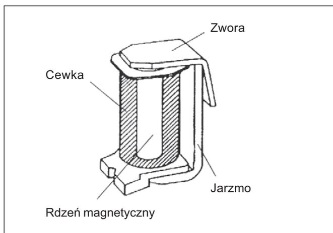
Rys.1 ukazuje klasyczny układ elektromagnesu składający się z czterech podstawowych części:
