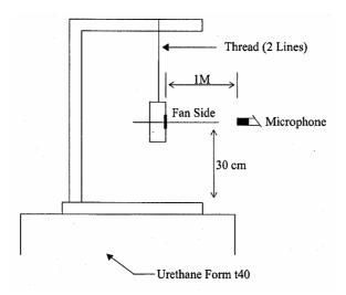
1 METER FROM MICROPHONE TO FAN INTAKE
