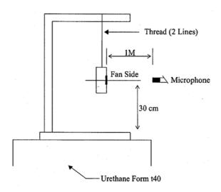
1 METER FROM MICROPHONE TO FAN INTAKE
