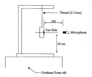
1 METER FROM MICROPHONE TO FAN INTAKE
