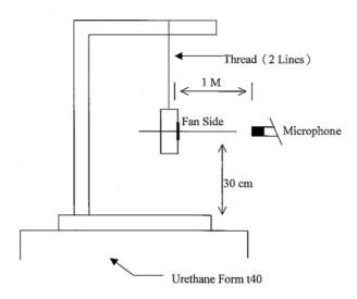
1 METER FROM MICROPHONE TO FAN INTAKE
