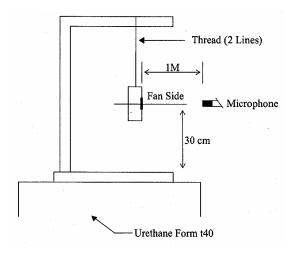
1 METER FROM MICROPHONE TO FAN INTAKE
